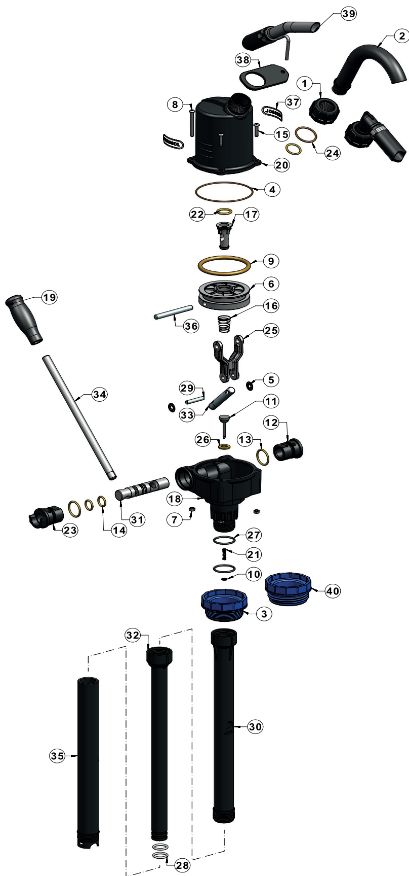
Obr. 9.-1: Rozložený pohled na sudové čerpadlo s vypouštěcím kolenem a přívodní hadicí
