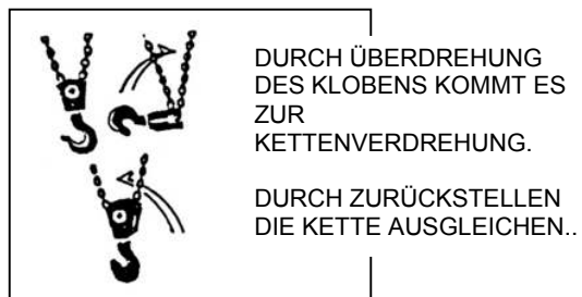
Abb. 2 Überdrehung der Kette
